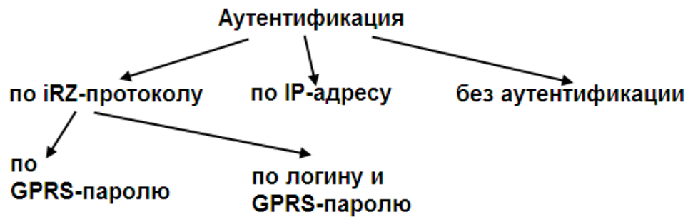
Рис. 4.8 Типы аутентификации клиентов при подключении к модему-серверу
