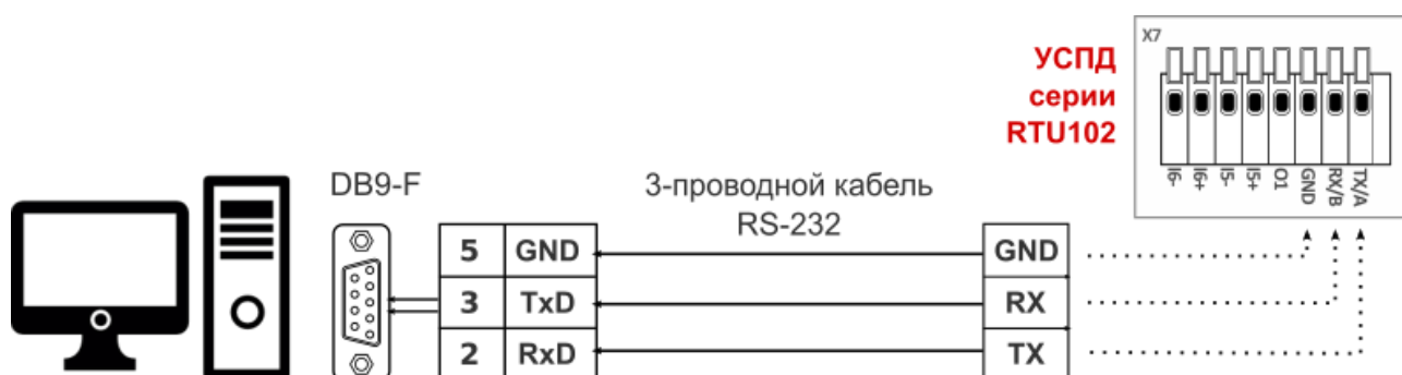
Рис. 41. Подключение УСПД серии RTU102 к ПК по интерфейсу RS-232.
