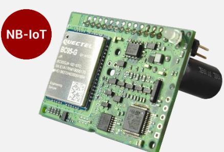
Модем: GPRS, NB-IoT и/или LTE Cat M1.
