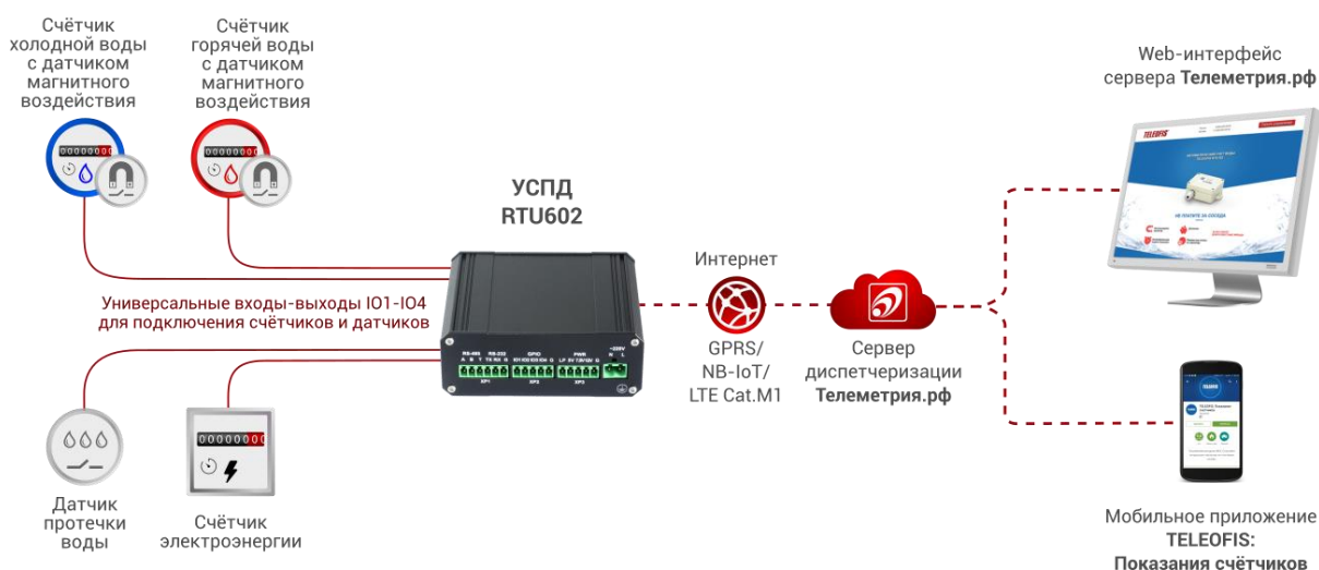
Рис. 16. УСПД RTU602 в системе учёта ресурсов.
