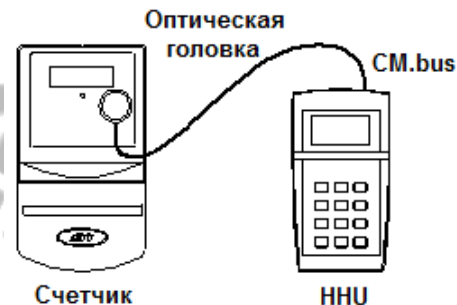
Рис. 4. Подключение модуля HNU к счётчику.
